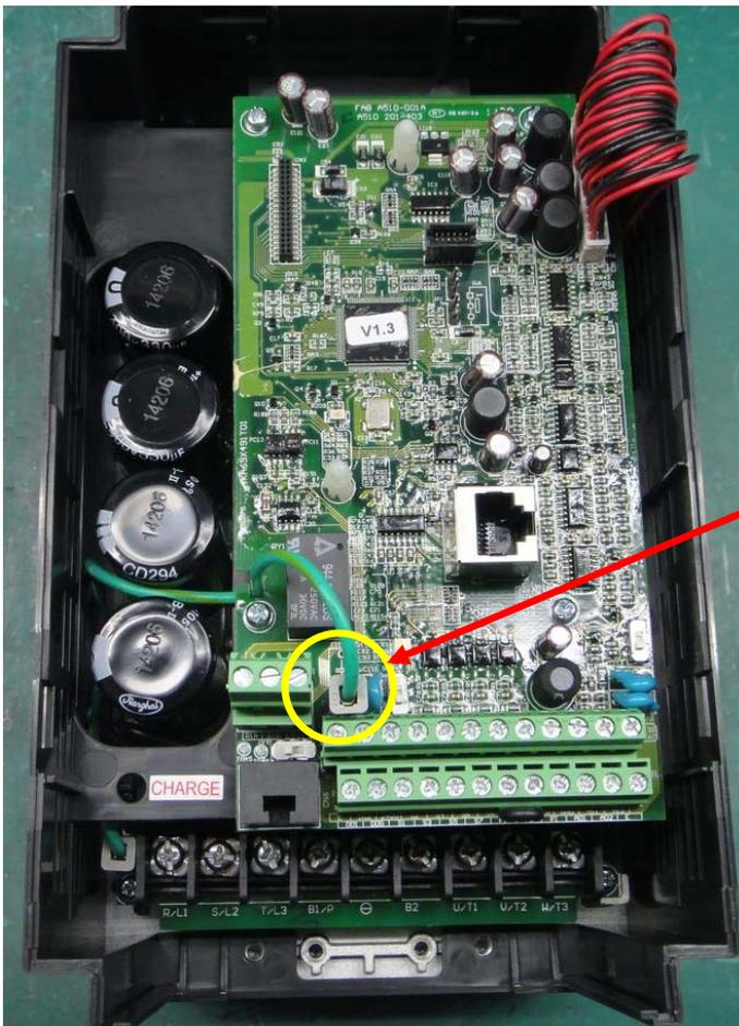
※ 拆除控制板(C/B)之J1. 接地線
