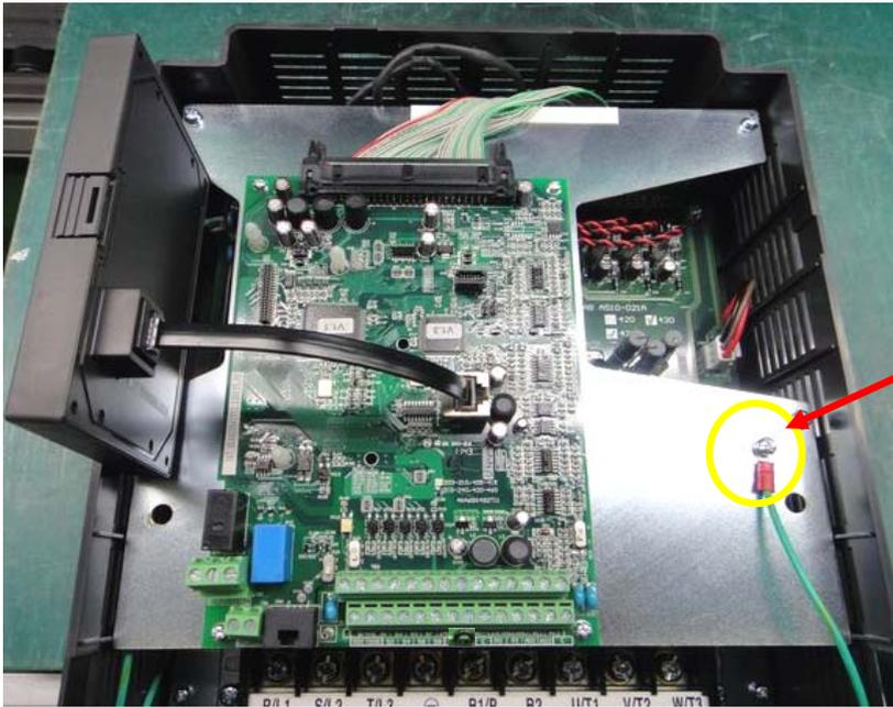
※ 拆除隔離鐵板之接地線
