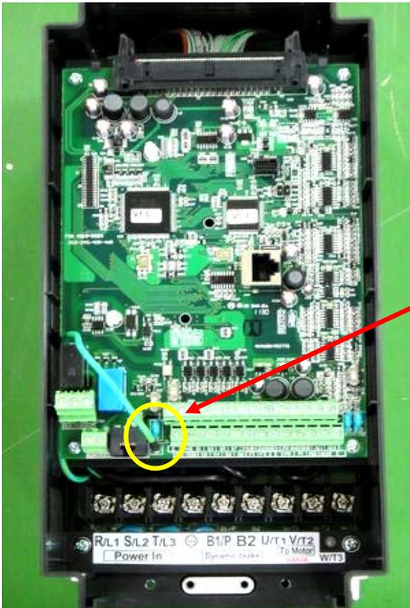
※ 拆除控制板(C/B)之J1. 接地線
